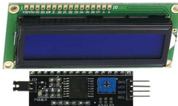
Рис. 17. Дисплей (жидкокристаллический индикатор — ЖКИ 16×2)
